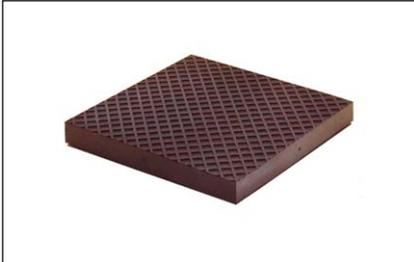
Maschinenlagerung zum Aufstellen von Maschinen. Riffelmuster auf der Unterseite ermöglicht den Ausgleich geringer Bodenunebenheiten.
