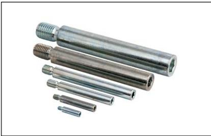
Führung und Zentrierung der Federn werden idealerweise mit Führungsbolzen (DIN 9835) erreicht. Sie sind erforderlich bei ungünstiger Federgeometrie und um ein Ausknicken bei Federsäulen zu vermeiden.
