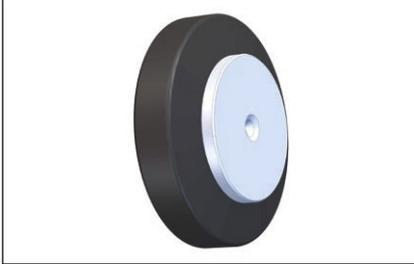
Reibräder bestehen aus einem Elastomerbelag und einem Metallkörper. Der Reibelag ist fest mit dem Metallteil verbunden. Die verwendete Elastomer-Mischung auf der Basis von Polychloropren hat eine Härte von 80° +/- 5 Shore A.
