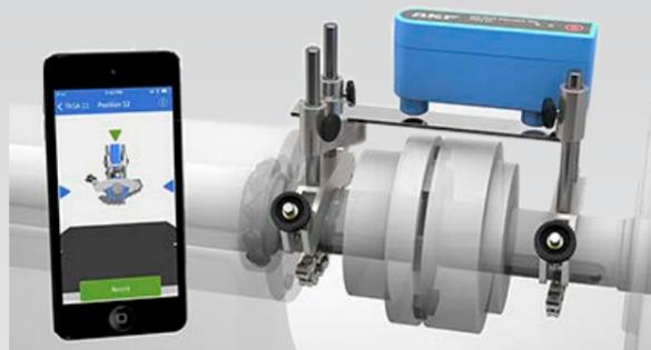
Mit dem SKF TKSA 11 beginnt eine neue Generation von Wellenausrichtsystemen. Das System arbeitet mit Smartphones und Tablets zusammen und führt den Anwender mit einfachen Anweisungen durch das gesamte Verfahren. Das TKSA 11 legt seinen Schwerpunkt auf die zentralen Ausrichtungsaufgaben.
