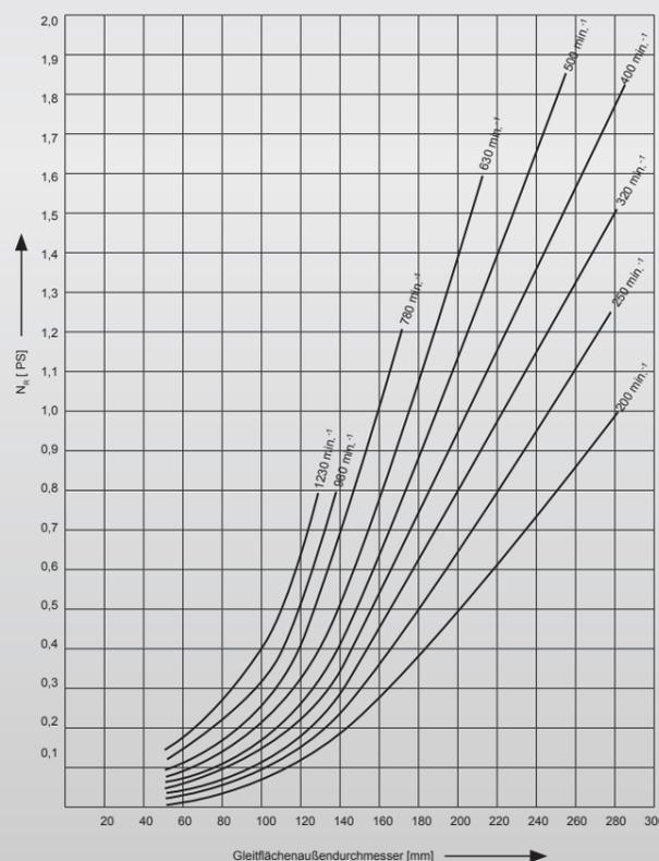
Die Grafik zeigt deutlich den großen Einsatzbereich der Laufwerkdichtungen. Auch im oberen Drehzahlbereich bis 10 m/s sind die Produkte unschlagbar. Besonders bei hohen Umfangsgeschwindigkeiten ist eine enge Zusammenarbeit der Konstrukteure mit unseren Anwendungstechnikern erforderlich, um auf konstruktivem Wege für ausreichende Kühlung und Schmierung der Dichtflächen zu sorgen.
