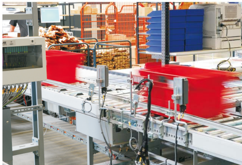
17 RFID-Schreib-Lese-Geräte versorgen im Logistikzentrum von Reiff die an den Behältern befestigten Chips mit Zielinformationen
